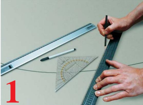
**1** Vorarbeiten: Falls ein Grundplatte aus Holz oder Pressspan verwendet wird, diese mit Weißleim (z.B. Busch Modellbaukleber 7599) bestreichen, um die offenen Poren zu schließen und damit eine bessere Haftung beim späteren Aufkleben der Einzelteile zu erreichen. Sinnvoll ist es, den Verlauf von Schienen und Straßen bzw. die weitere Landschaftsgestaltung zu planen und auf die Grundplatte aufzuzeichnen.
